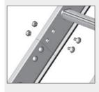
Die Dachauflegeleitern werden mit den Verbindungslaschen Art.-Nr. 1049.x03 verbunden. Die Schrauben, Scheiben und Sicherungsmuttern sind im Lieferumfang vorhanden. Es müssen pro Lasche 4 Schrauben verwendet werden. Es können bis zu drei Leitern gestoßen werden, ohne dass zusätzliche Dachhaken verwendet werden.
